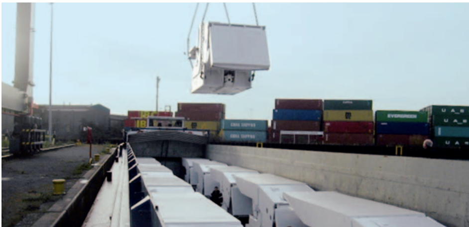
Verladung der Mining Shields auf das Binnenschiff
